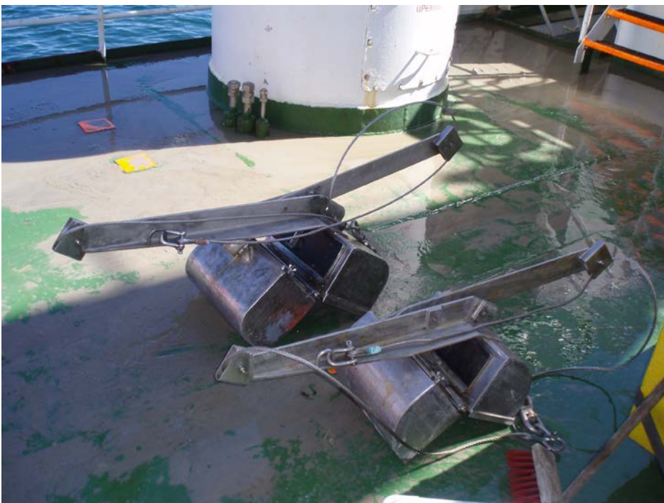
Figur 3: Kombigrabb på 0,15 m 2 (øverst til venstre) og tradisjonell grabb på 0,1 m 2 (nederst til høyre).
